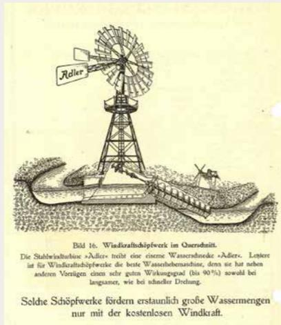
Bild 16. Windkraftschöpfwerk im Querschnitt.
